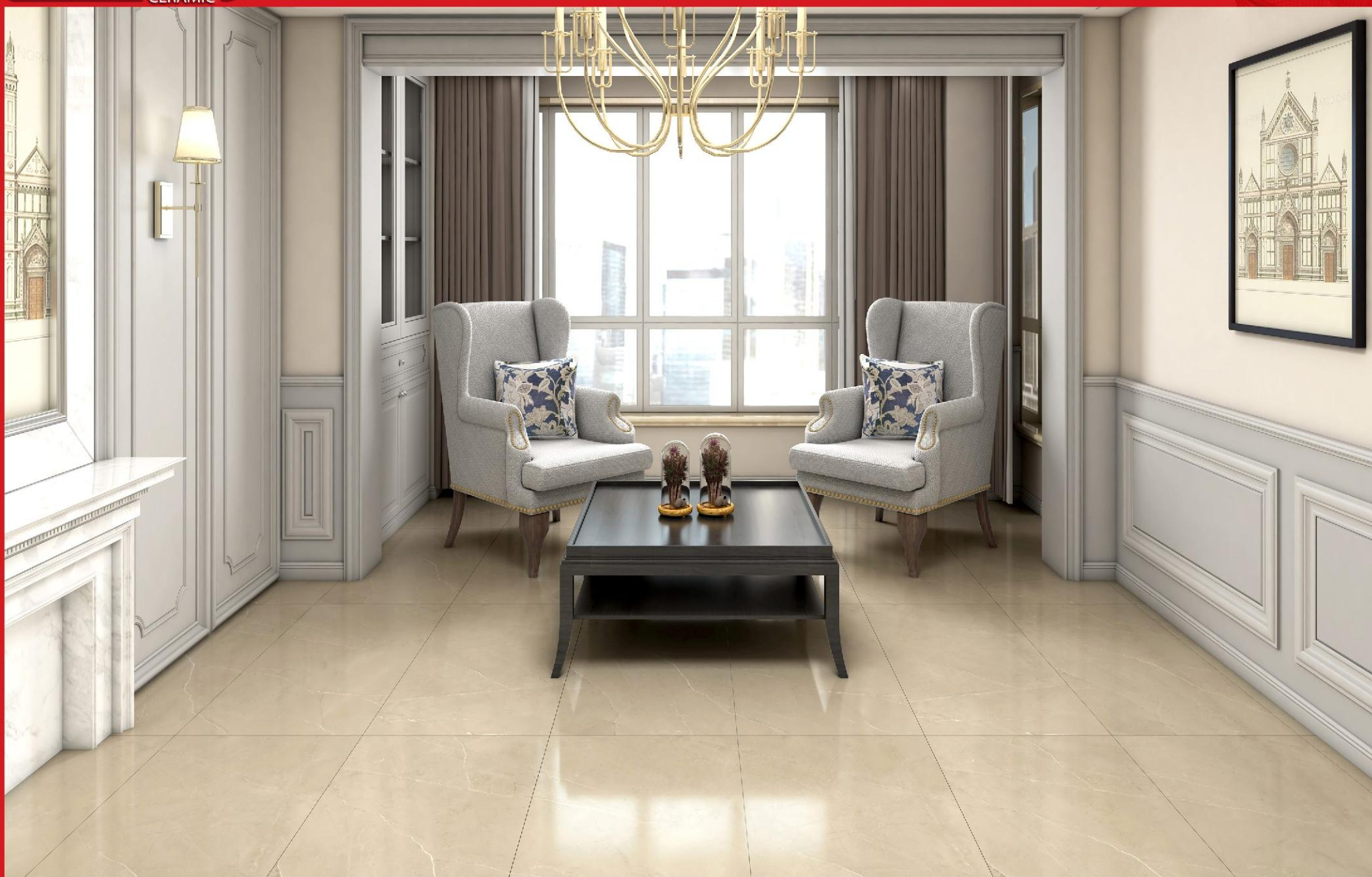
متريال کاشی و سراميك طول عمر بسيار بالايی دارند و در برابر سایش نيز بسيار مقاوم هستند. کاشی پرسلانی هم نمونه‌ای از اين دسته متريال‌ها است که به خاطر بافت يکنواخت و فشرده‌اي که دارد نسبت به سایر کاشی‌ها، سخت‌تر و مقاوم‌تر است و در نتيجه طول عمر بالايی نيز دارد.
